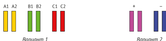
Рис. 4. Шинопроводы с расщепленными фазами.
