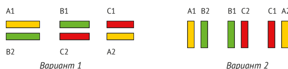
Рис. 5. Схемы шинопроводов со спаренными фазами.
