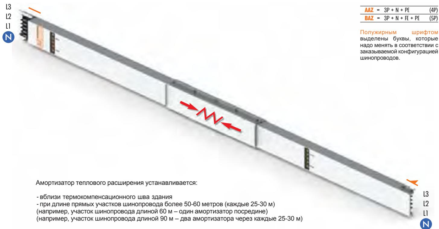
Амортизатор теплового расширения устанавливается:
