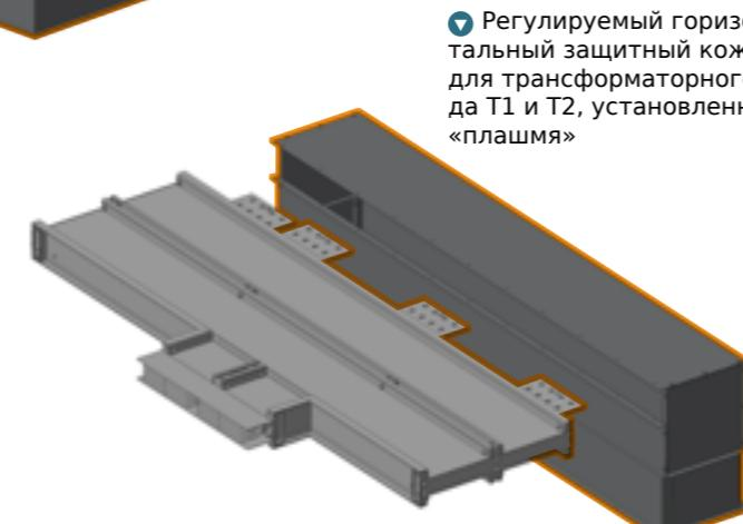
Регулируемый горизонтальный защитный кожух для трансформаторного ввода T1 и T2, установленных «плашмя»
