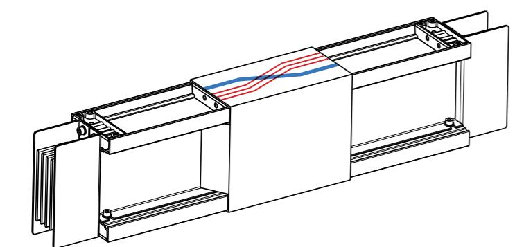
**Секция перехода нейтрали 1000 мм,** предназначена для смены чередования нормали шинопровода, её минимальный размер составляет 1500 мм.
