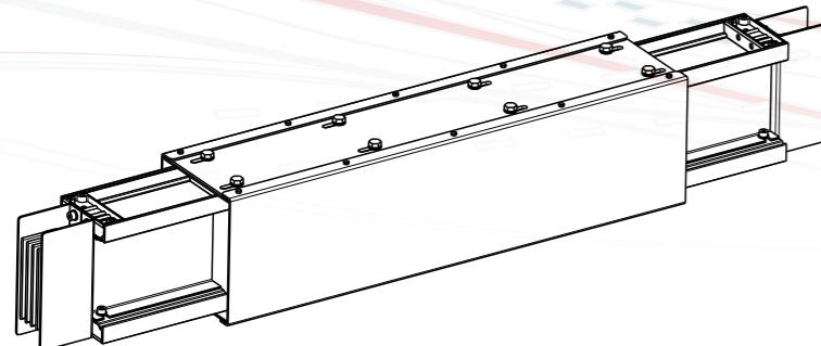
**Секция термокомпенсации 1500 мм,** используется для компенсации теплового расширения. Как правило устанавливается на прямых участках более 30 м. На участках выше 60 м устанавливаются две, выше 90 м три и т.д.
