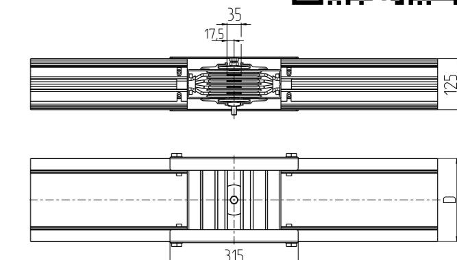
За счет конструктивных особенностей соединительного блока, места соединений не нуждаются в обслуживании на протяжении всего срока службы шинопровода.
