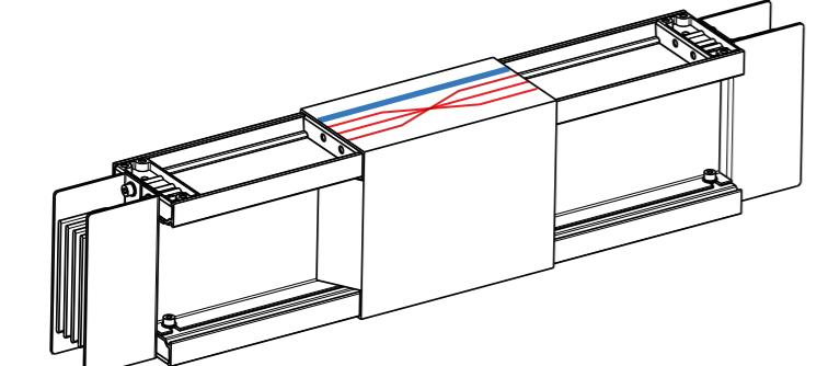
**Секция перехода фаз 1000 мм,** предназначена для смены чередования фаз шинопровода, её минимальный размер составляет 1500 мм. Последовательность фаз на обеих сторонах определяется заказчиком.
