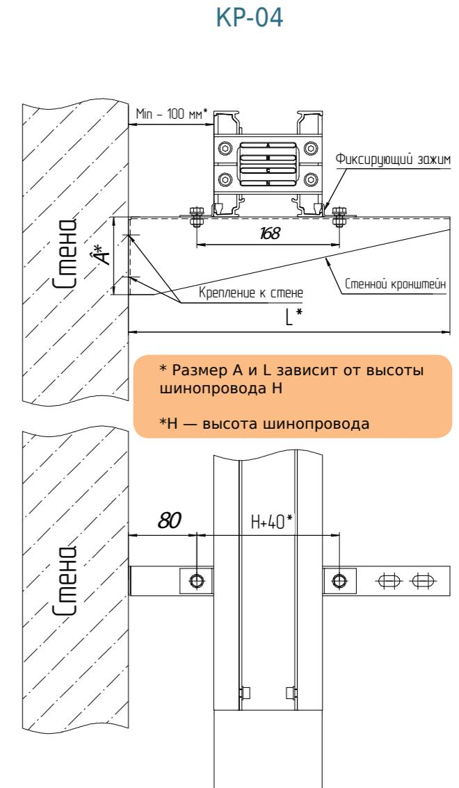
Жёсткое крепление применяется на участках без элементов термокомпенсации и для фиксации элементов смены направления шинопровода (углах, тройниках и т.д.)
