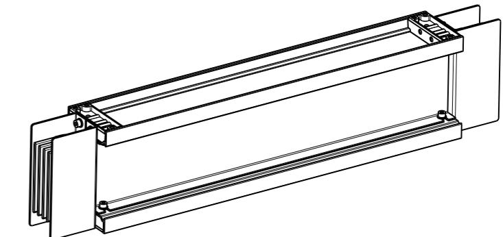
Минимально возможный размер секции длиной 500 мм.
