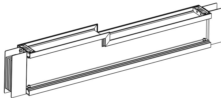
**Секция понижающая 1500 мм,** используется для уменьшения сечения шин, питающих конечного потребителя. Такой подход позволяет сэкономить средства, обеспечивая оптимальное распределение электроэнергии. Возможно изготовление секций понижающих с защитой менее мощного участка линии (автоматическим выключателем, расцепителем, плавкой вставкой)
