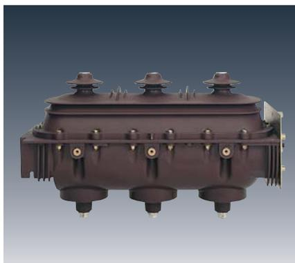
Трехпозиционный аппарат выключателя нагрузки (разъединителя) и заземляющего разъединителя, находящийся в одном корпусе, заполненном элегазом и «запаянном на весь срок службы».
